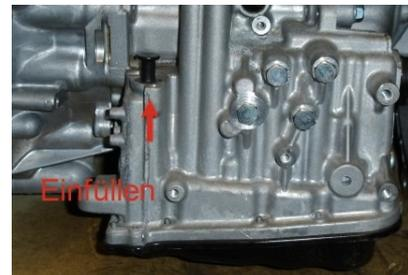
Ölkontrolle immer bei laufendem Motor!
